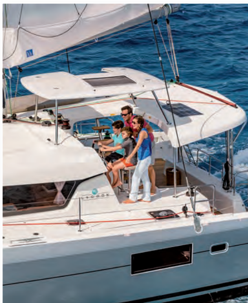
↑ La navstation regroupe le poste de pilotage et la manœuvre en pied de mât : une vraie réussite
