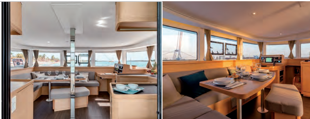
Le vaigrage du plafond est réalisé en toile tendue, effet décoratif réussi et poids plume ↓
